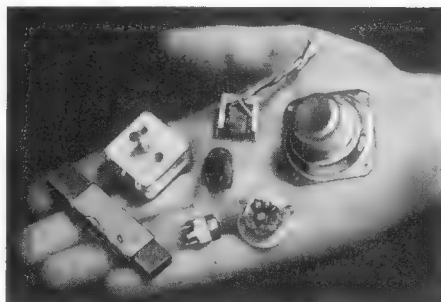
Bild 1. Eine „Handvoll“ der wichtigsten Bauteile für einen Miniatur-Taschensuper. Von links nach rechts: Flachstab-Ferritantenne, Zweifach-Drehkondensator, zwei Zf-Filter, Nf-Übertrager (oben), Lautstärkereglern mit Schalter und Drehknopf (unten), permanentdynamischer Lautsprecher
